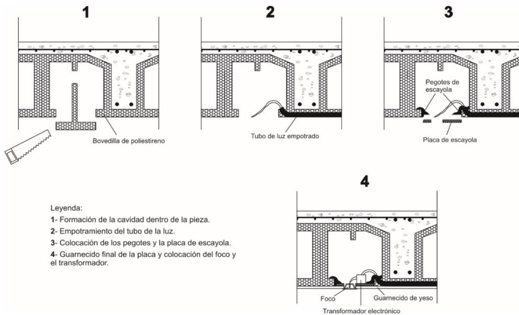
La colocación de lámparas halógenas en techos acabados con enlucido de yeso (sin falso techo) es similar a la empleada en forjados de bovedilla tradicional. Como paso previo localizaremos la zona aligerada en la bovedilla (zona hueca) dando un golpe con los nudillos de la mano sobre el techo. Esta es la única zona donde podremos colocar las lámparas halógenas.
