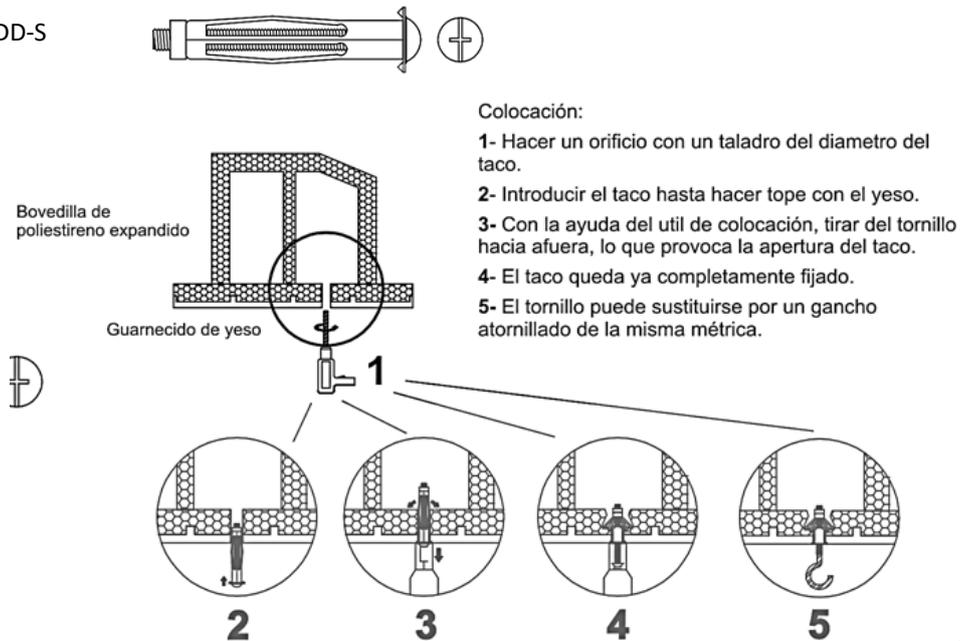
Si el punto donde se quiere colocar el anclaje coincide con un nervio o zona maciza (zuncho, jácena o ábaco), se utiliza una broca convencional y taco específicos para hormigón, cuidando que la longitud de éste salve los 3 cm de poliestireno.
